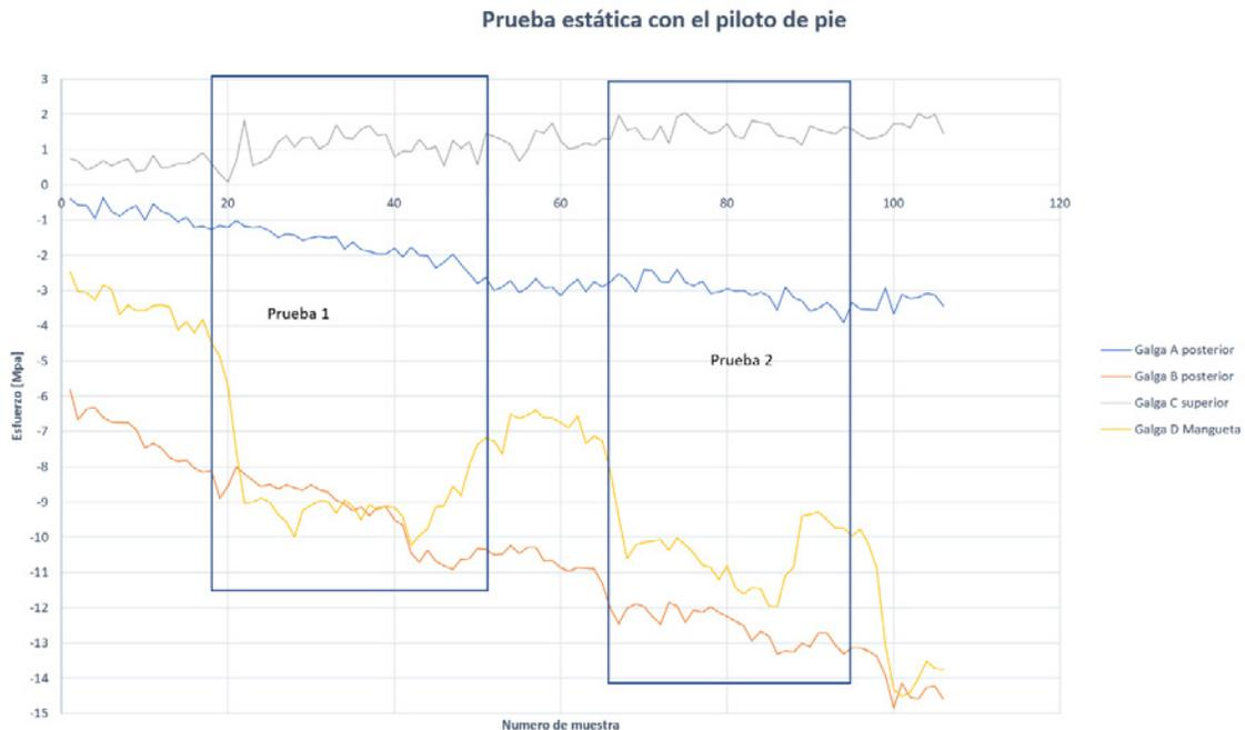
Figura 16. Pruebas estáticas donde el piloto se encuentra de pie en el centro del prototipo.
