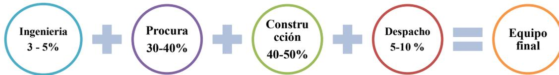
Figura 3: Proceso general de construcción de un equipo bajo estándar ASME y su porcentaje promedio que representa en el costo final del equipo
