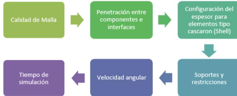
Figura 7. Proceso de verificación antes de ejecutar la simulación.
