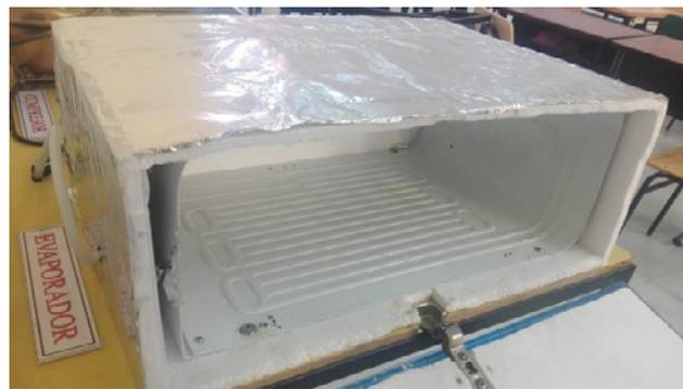
Figura 2: Evaporador y compartimiento de refrigeración
