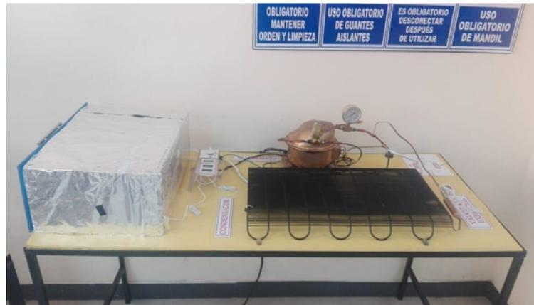
Figura 4 Prototipo de Refrigeración Doméstica
