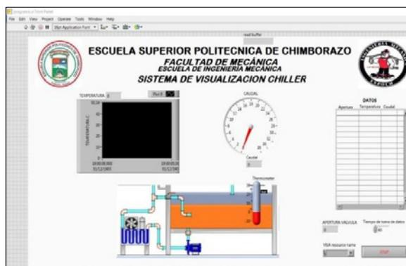
Figura 1: Interfaz de usuario en el software LabView
