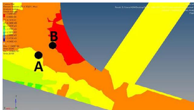
Figura 11. Esfuerzos en el soporte inferior de la rueda posterior.
